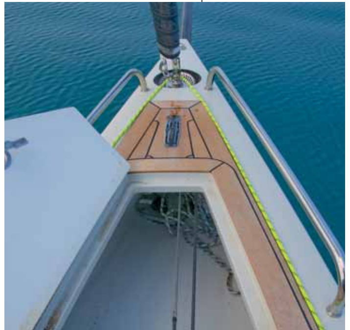
Der Ankerkasten beherbergt auch die Technik des versenkt eingebauten Fockrollers.
