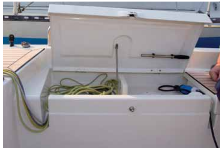
Tampen verschwinden unter dem Deckel der Längsduchten. Unter dem hinteren Deckel ist eine tiefe Backskiste für Fender, Festmacher oder anderes Zubehör.
