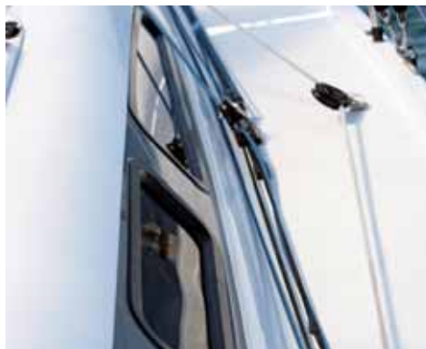
Leicht verstellbar sind die Genuaholepunkte.
