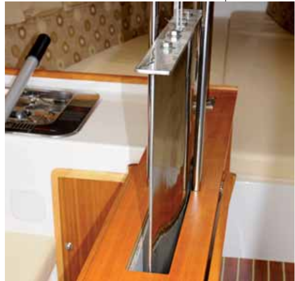
Saubere Arbeit: Die Kiefflosse ist aufwändig aus Edelstahl geschweißt und mit einem hinterschnittenen Profil versehen.
