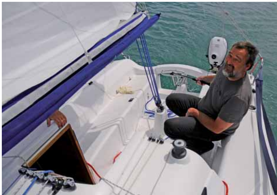
Der Pinnenausleger sollte für effektiven Gewichtstrimm teleskopierbar sein. Das Schotpedest ist sinnvoll und eine Hahnepot oder ein Traveller würde den Stand des Großsegels noch verbessern.
