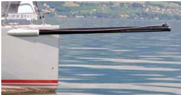
Rüsseltier: Der Carbon-Gennakerbaum ist fast zweieinhalb Meter lang. Halsen wird damit zum Kinderspiel. Clever: Die Leine unter Deck zum Ausfahren läuft im Handlauf.
