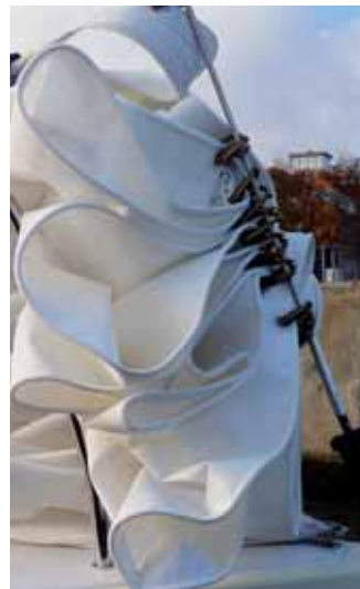
Statt eines Profilvorstages hat die VA 44 Stagreiter. Das hat auch seine Vorteile wie den des schnellen Vorsegelwechsels.
