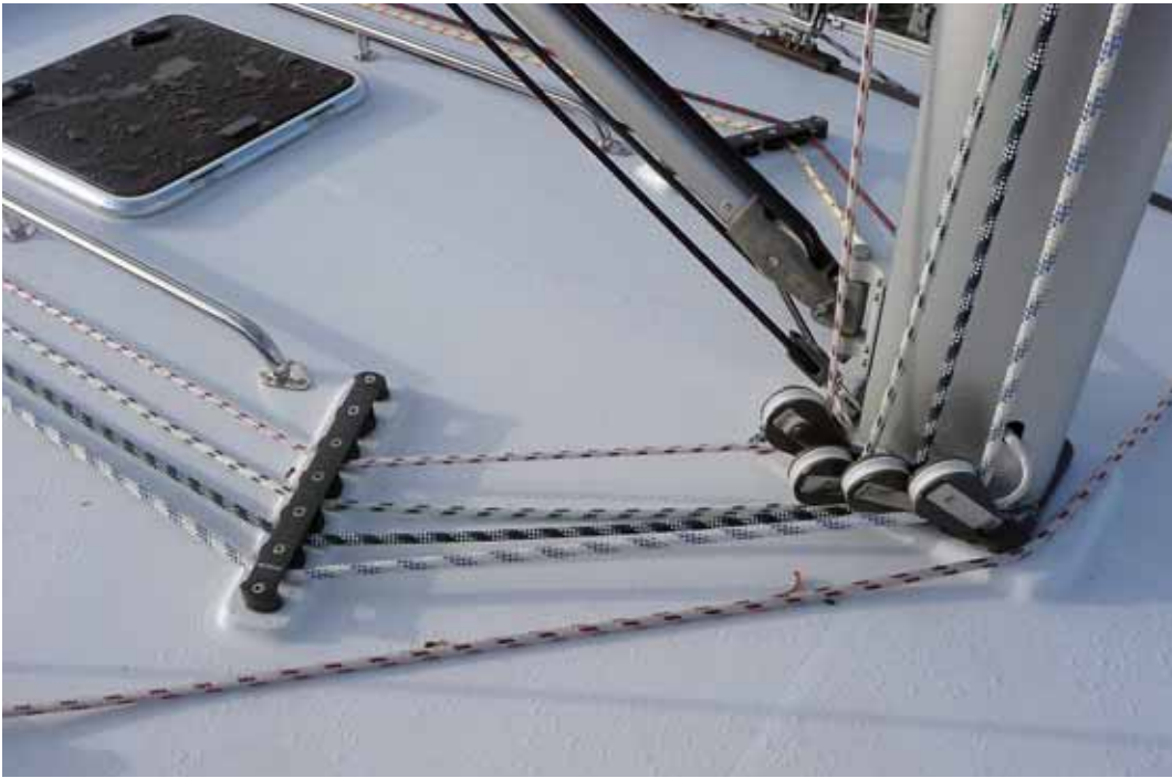
Die Fallen und Strecker laufen außen am Mast und dann nach Achtern. Auf Abdeckungen hat man verzichtet.
