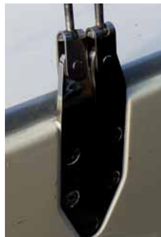
Die soliden Püttings sind außen montiert.
