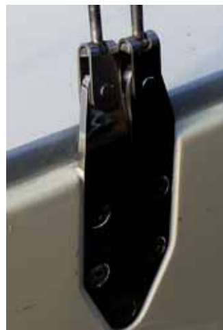
Die soliden Püttings sind außen montiert.
