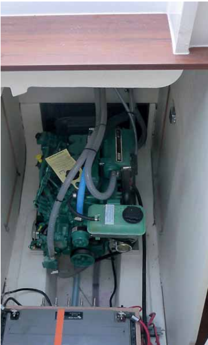
In der VA 44 ist ein 29 kW / 40-PS-Motor eingebaut. Damit erreicht man eine Marschfahrt von sieben Knoten. Gegen Aufpreis gibt es 53 PS.
