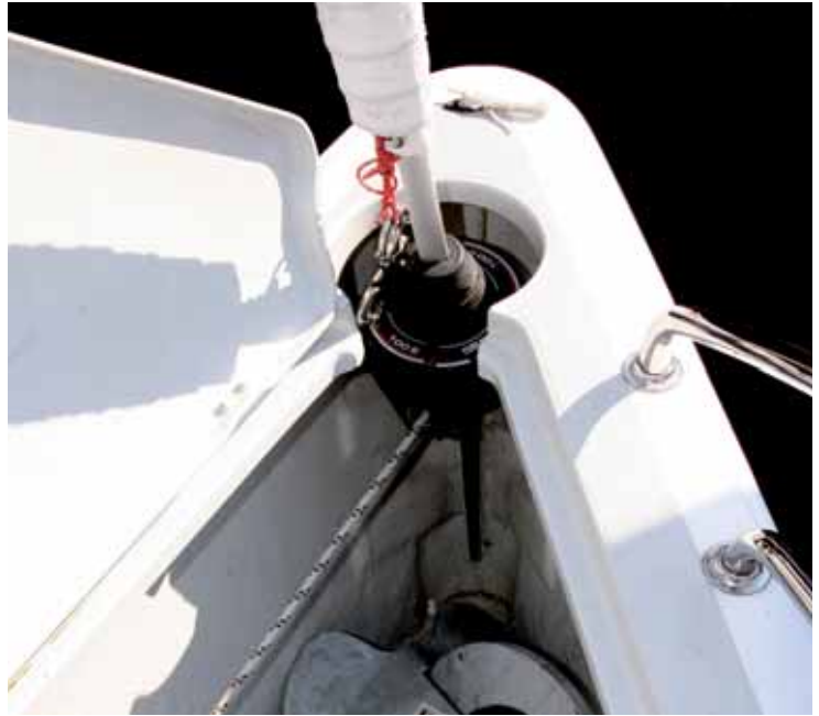
Der Fockroller ist unter Decksniveau eingebaut. Das Segel passt aber nicht hundertprozentig.
