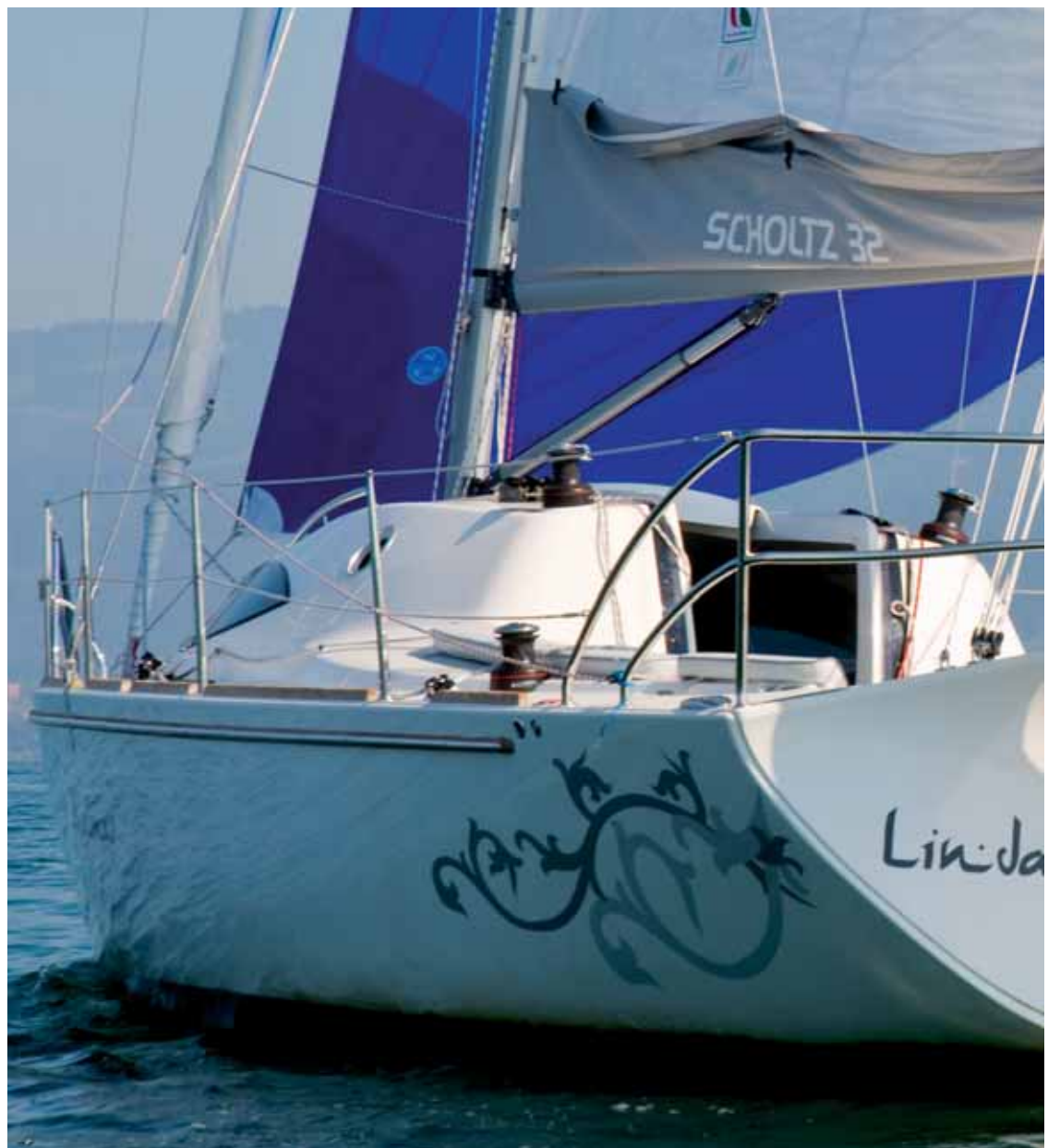
Das markante Heck: Der Sitz für den Rudergänger ist nach achtern ausgebaut. Das schafft Platz in der Plicht. Er kar
