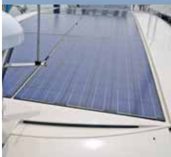
Sechs Solarzellen auf dem Dach: Im Idealfall liefern sie mit 1300 Watt die Energie, die man für den E-Antrieb braucht.
