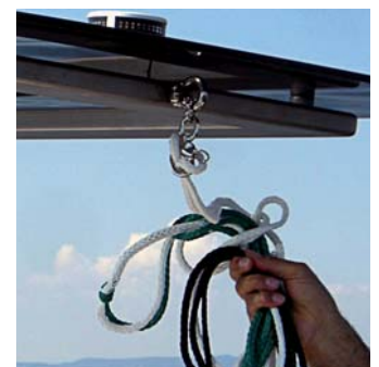
An dem Haken lassen sich Wasserski- oder Schleppleine anhängen.
