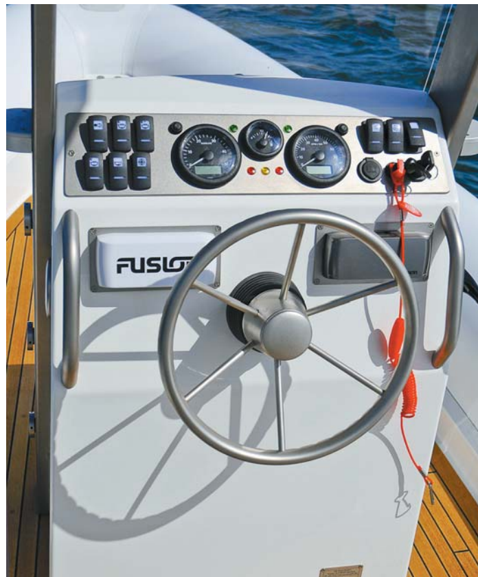
Der Steuerstand mit klassischen Rundinstrumenten von VDO. Extra sind das wasserdichte Radio (links) und die Dockingstation fürs iPhone.
