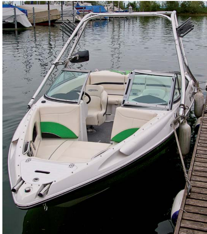
Der offene Bug der Campion bietet Platz für zwei Personen. Unter den beiden seitlichen Abdeckungen sind die Bugscheinwerfer versteckt.
