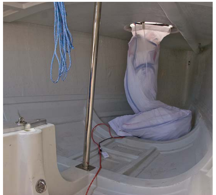
Eine Bergertrompete für den Gennaker vorzusehen, ist grundsätzlich eine gute Idee. Diese ist aber noch nicht der Weisheit letzter Schluss. Das Segel rutsch nicht über das Deck ins Loch.
