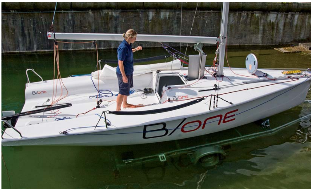
Das Boot kann problemlos geslippt werden. Der Galgen mit Winde für die Kielflosse ist gut zu sehen. Gut gelöst ist die versenkte Anbringung des Gennakerbaums in einem Kanal an Deck.
