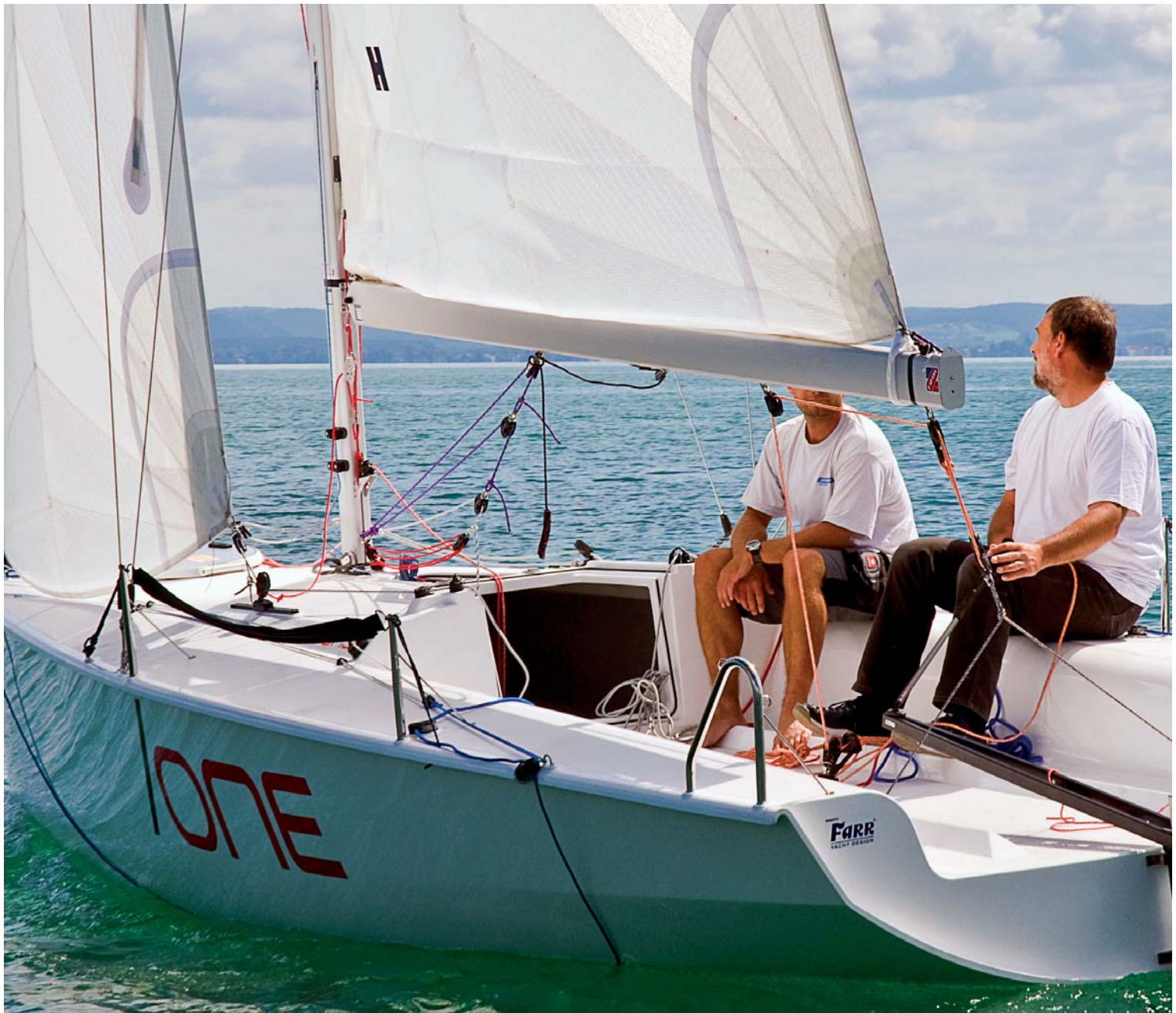
Moderne Rumpflinien beeindrucken durch ausgezeichnete Segeleigenschaften und hohe Leistung. Bei der Decksrüstung hätte sich die Werft mehr Mühe unausgegoren und improvisiert. Auch ist der Pinnenausleger für sauberen Gewichtstrimm kurz geraten.
