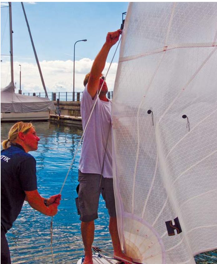
Noch nicht ganz praxistauglich: Das Vorsegel wird in Star-Manier mit Reißverschlusstasche am Stag befestigt. Dabei verläuft das Fockfall ebenfalls innerhalb der Tasche. Alleine lässt sich das Segel kaum setzen und für zwei Personen ist das Vordeck sehr eng.
