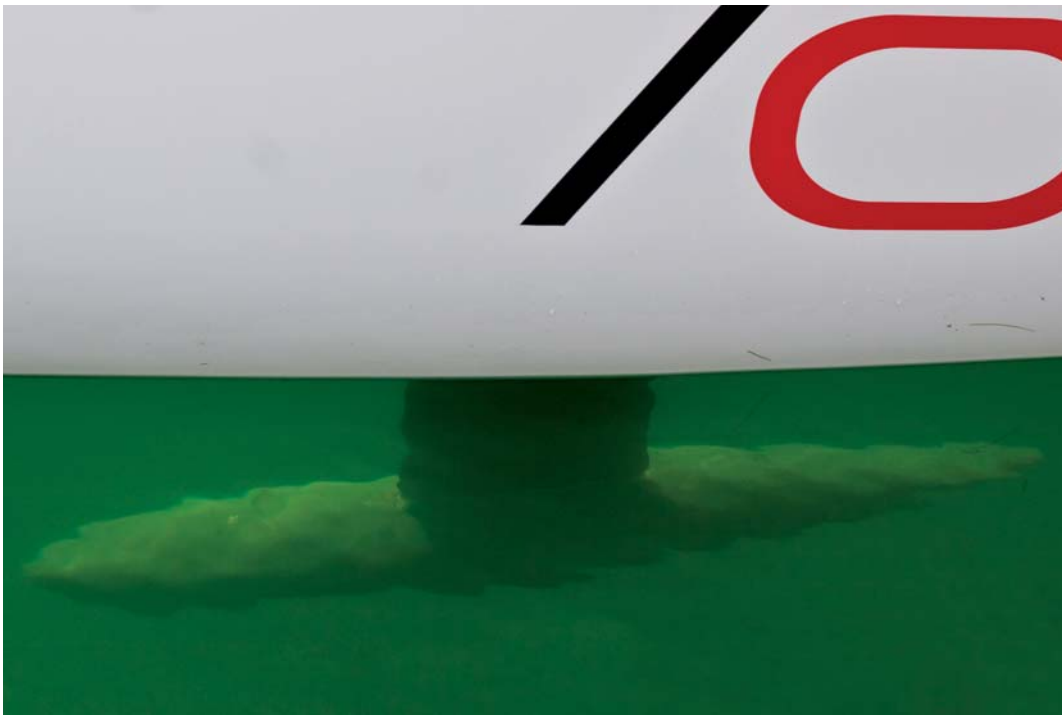
Schmale Alu-Flosse mit T-Bulb aus Gusseisen. Was strömungstechnisch und statisch vorteilhaft ist, hat Nachteile bei engen Manövern mit geringen Geschwindigkeiten. Außerdem sollte man Seegrasfelder meiden.
