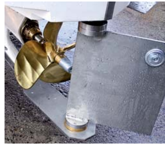
Megastabiles Ruderblatt mit von Hacke geschütztem Propeller.
