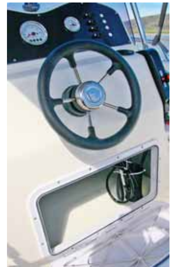
Zugang zur Technik in der Steuerkonsole.
