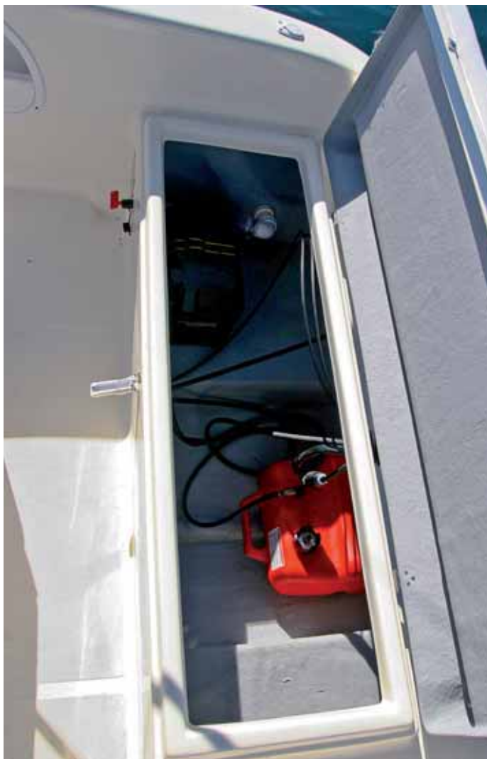
Unter der achteren Ducht ist der Tank sowie die Batterie eingebaut. Es bleibt noch viel Platz für weitere Ausrüstung.
